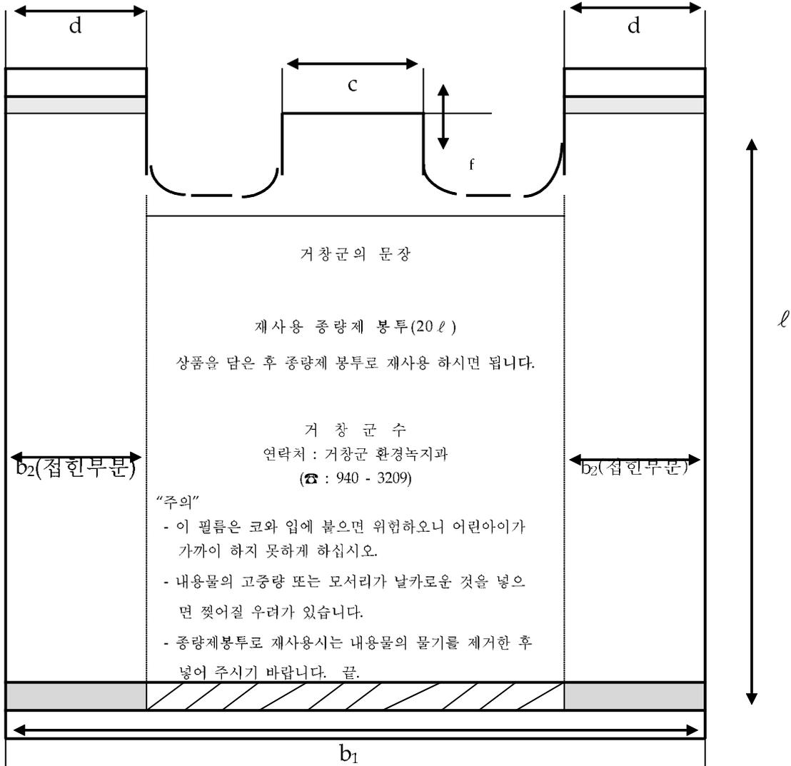
비고 1.  $l$ 은 봉투의 높이, 봉투의 너비는 접힌부분을 펼친 전체너비  $b_1+2b_2$ 로 하고,  $b_1$ 은 봉투의 마무리 너비,  $b_2$ 는 접힌부분의 접혀 들어간 너비,  $c$ 는 묶는선 폭,  $d$ 는 손잡이끈 폭,  $f$ 는 묶는선 길이임.
